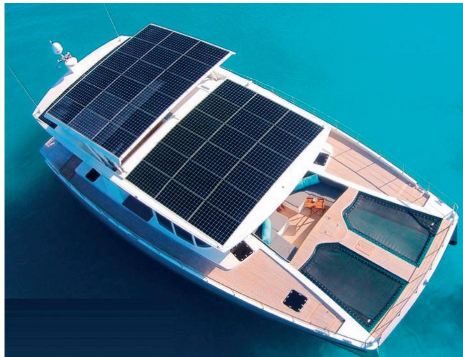
Silent 55 – smještaj fotonaponskih panela
