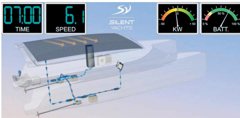
Ujutro se motori napajaju energijom iz baterija i započinje proizvodnja energije iz FN modula.
