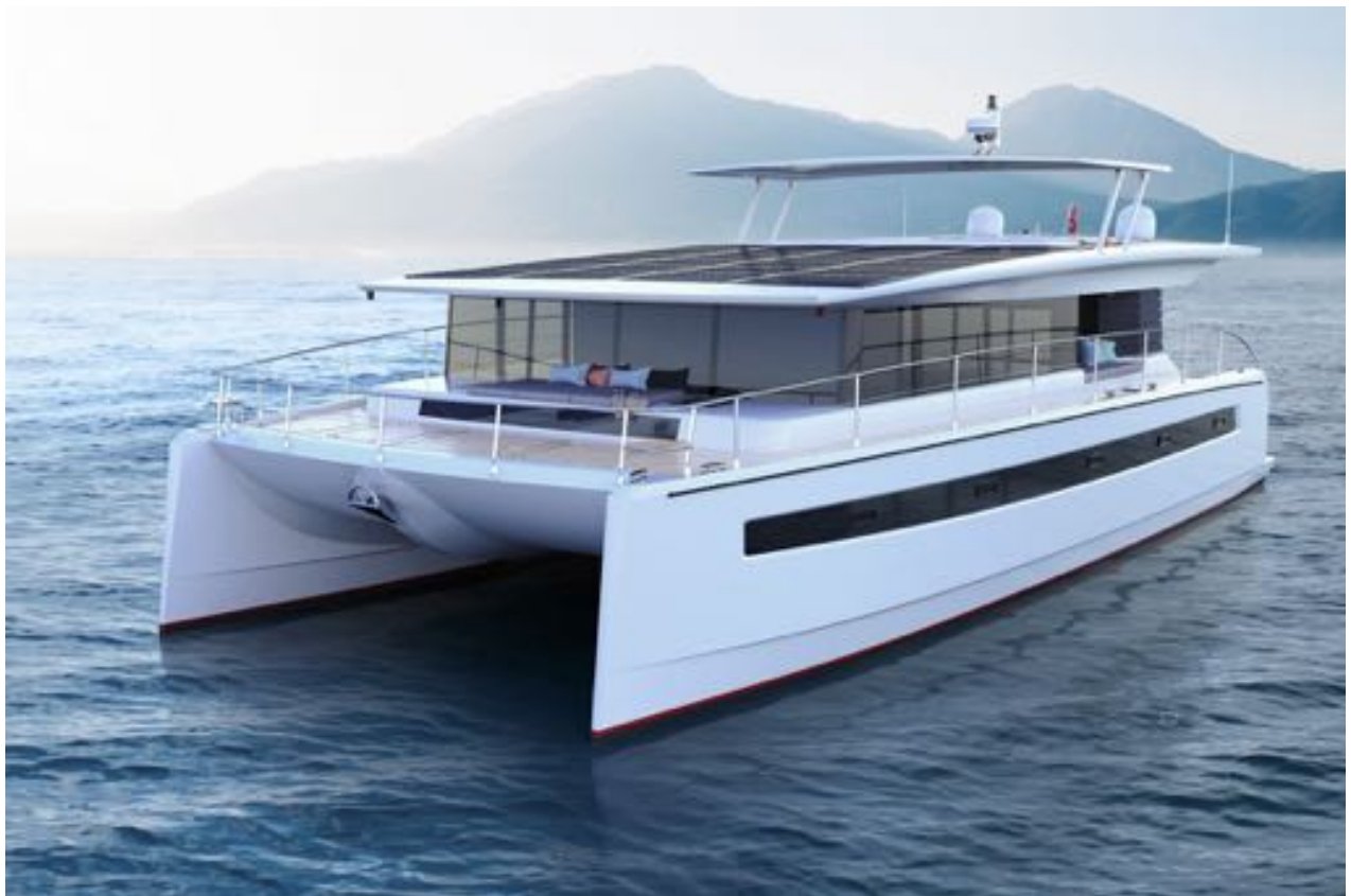
Der erste Silent Kat mit negativem Steven © Werft
