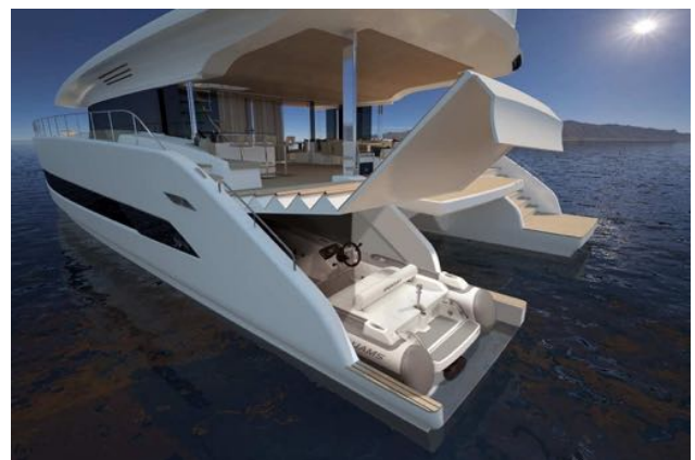
Der Tender verschwindet im Backbordrumpf © Werft
