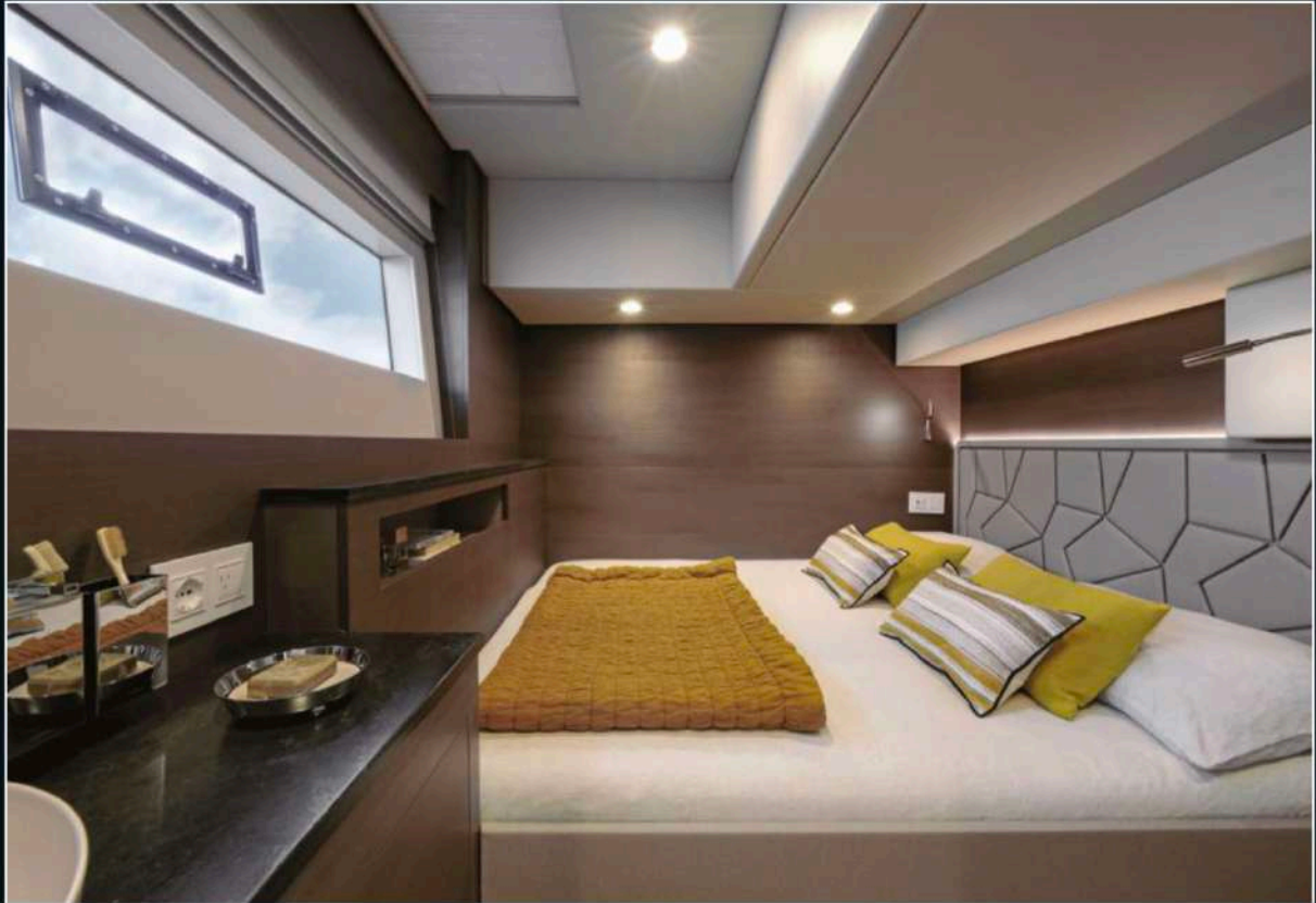
Une cabine double arrière présente un lit travers à la marche pour compenser la faible largeur des coques.
